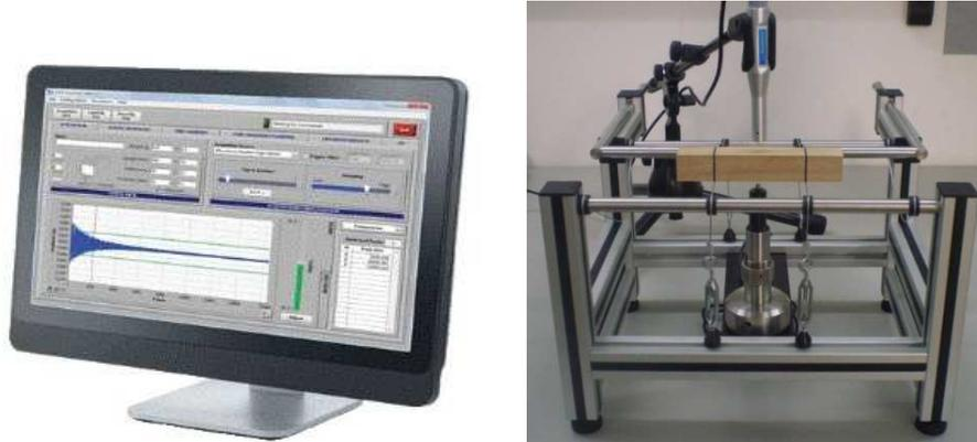
**Figura 10** - Equipamento desenvolvido pela ATCP Engenharia Física ([Sonelastic®](http://www.sonelastic.com)) para medição dos módulos elásticos empregando a Técnica de Excitação por Impulso.
