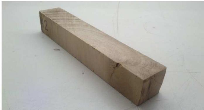
**Figura 9** - Corpo de prova com orientação mista entre radial e tangencial na direção do comprimento.
