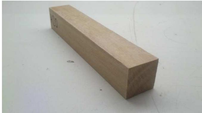
**Figura 8** - Corpo de prova com orientação das fibras na direção do comprimento.
