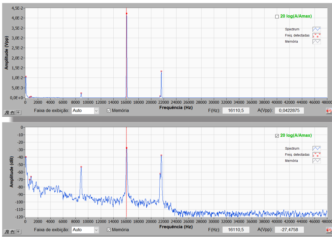
Figura 44 - Exemplos de um espectro na escala logarítmica (abaixo) e na escala linear (acima).
